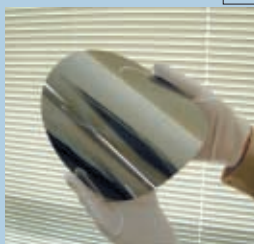
20 \mu mまで薄削りしたウェーハ
