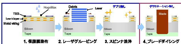
Fig. 1 レーザ+ブレードダイシング
