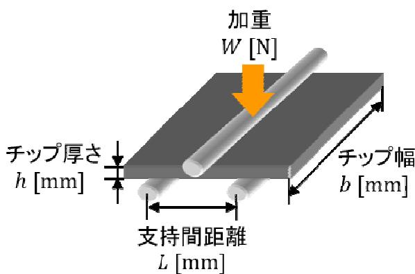
Fig. 2 三点曲げ抗折強度測定
